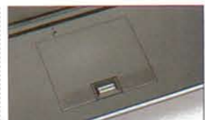
En la parte central de los botones del touchpad existe un lector de huellas digitales.
